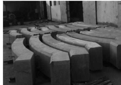
图3 荣大生产的熔铝炉拱顶预制件
